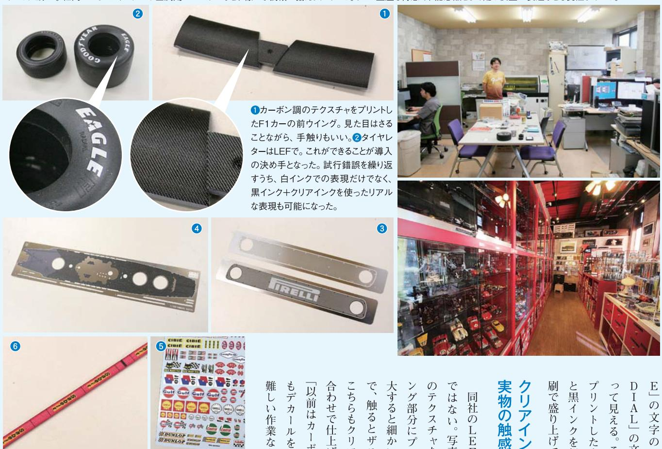
③金属製のメッシュパーツ。上のパーツにプリントすると、下のように仕上がる。④戦艦「大和」の甲板パーツ。ステンレス製で、エッチング処理が施してある。この上からLEFを使って質感を再現している。⑤LEFで作ったデカール。元々のデカールに艶があるため、それをクリアインクを使って再現している。⑥シートベルトのパーツにもLEFでフルカラープリント。このパーツの幅は5mm程度だが、プリント位置も精度も見事に仕上げている。
