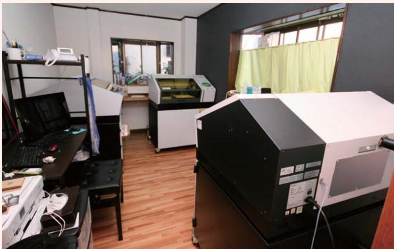
オバタ工芸の製造システム。上写真はLEF-12が2台、LEF-20が1台の計3台が並ぶ作業場。右上は工場に設置されたCCDカメラ付きレーザー加工機「ドラゴン」。右下は長年使われてきたシルク印刷機。
